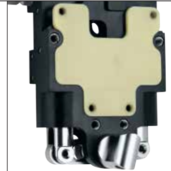
Optionale Isolations-Platten aus extrem elastischem G10 verbessern die Last-Verteilung durch direkte Uebertragung des Moments auf den Montage-Grund.
