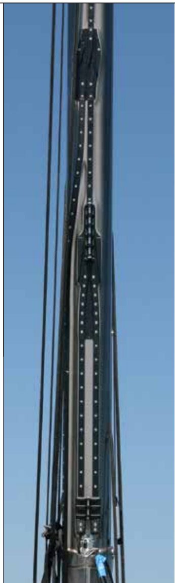
Das Trisegel Weichensystem ist mit dem Battcar T-Schienen System integriert indem beide eine Mast-schiene teilen um Gewicht in der Höhe zu reduzieren.
