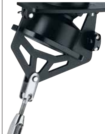
Spannschloss verbindet Auge am Bügel mit unterdeck Pütting.
